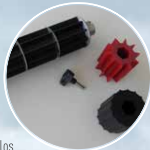
kit para siembra de granos gruesos mecánico o neumático
