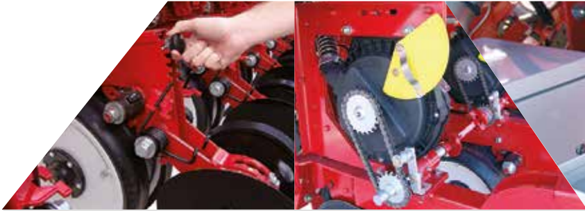
Regulación de profundidad de semillas y tapadoras a palanca.
