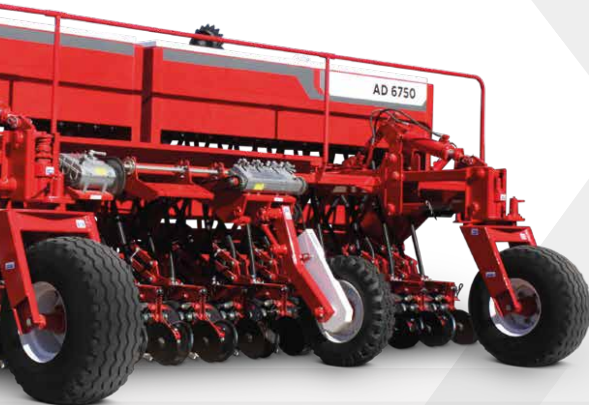
Regulación de profundidad de semillas y tapadoras a palanca.
